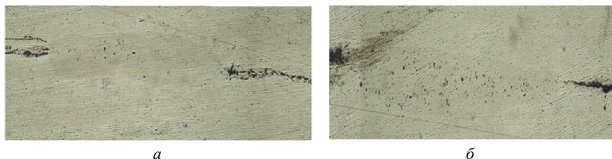
Рис. 5. Мікроструктура зварного з'єднання сплаву АД00 (а) та Д1 (б), отриманого через модифікований титаном шар (оптична мікроскопія, \times 20 )
