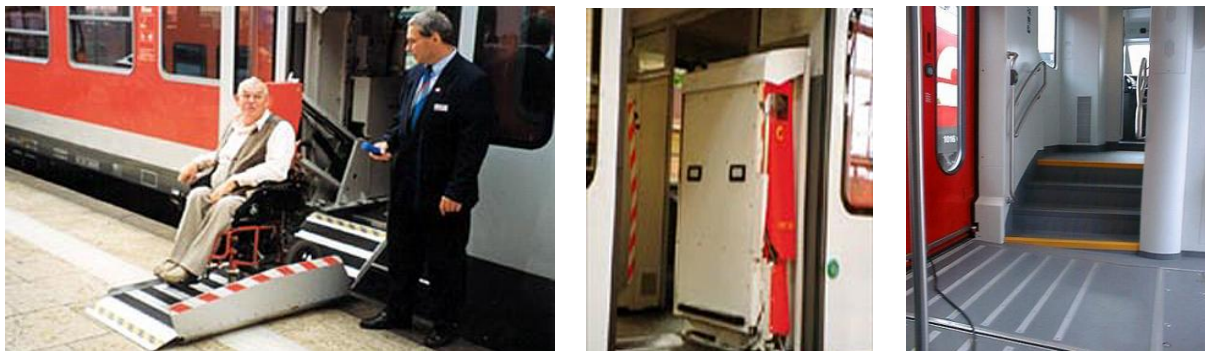
Рис. 6. Вспомогательные устройства для подъема пассажиров в вагон на инвалидных колясках
