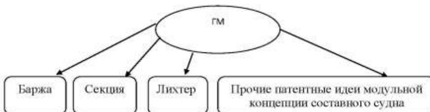
Рис. 3. Типы грузовых модулей составных судов
