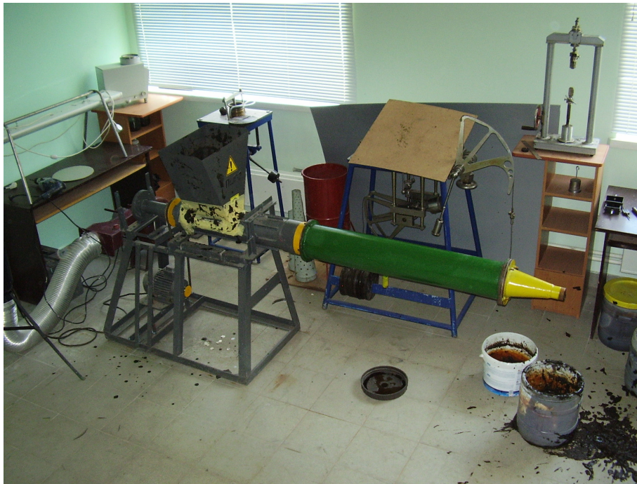
Рисунок 1 – Лабораторна установка для дослідження віджиму сапропелю
