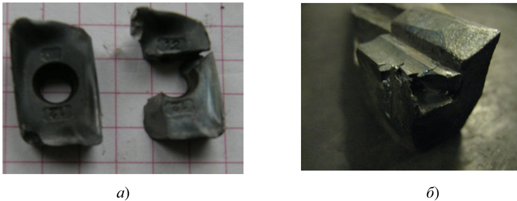
Рисунок 3. Руйнування змінної фрезерної пластини R390-180G12M-PM (а) та напайної різальної пластини з T5K10 (б)
