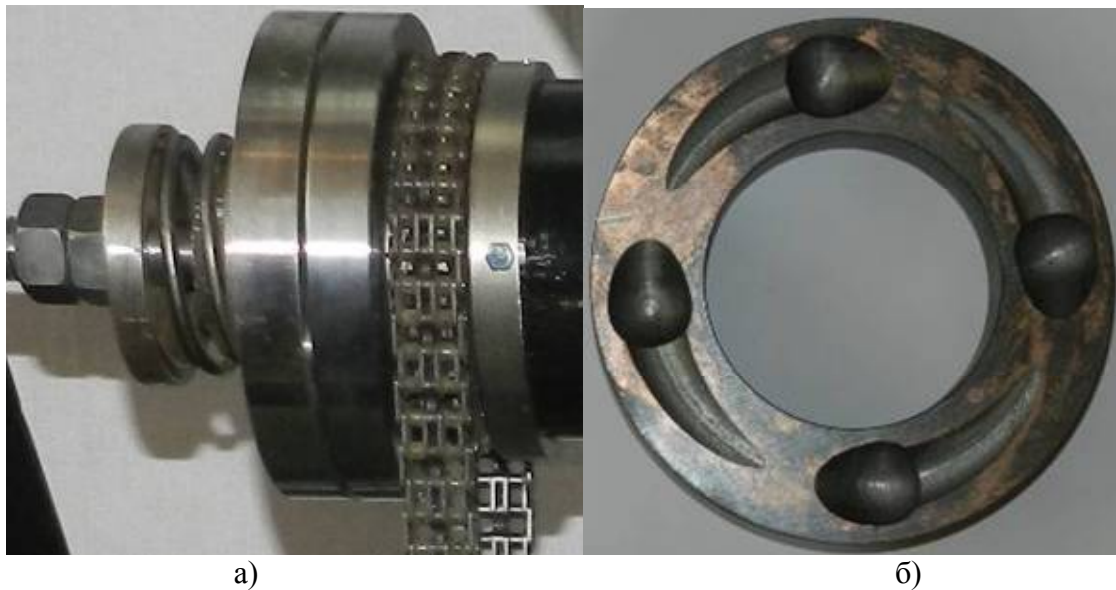
Рисунок 2. Загальний вигляд (а) запобіжної муфти та загальний вигляд (б) робочої поверхні веденої півмуфти
