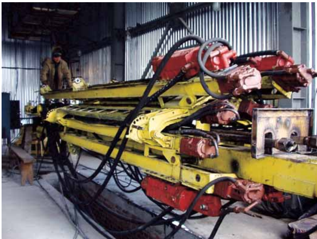
Обслуживание ствовой бурильной установки БУКС-1М.
