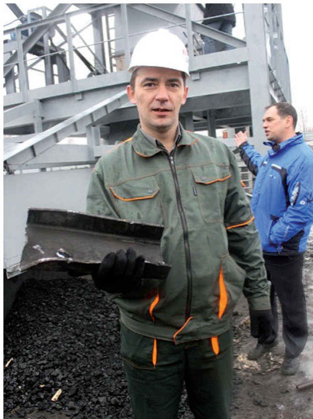
Недробимый предмет (швеллер) после неоднократного прохождения через дробилку Gundlach, оснащенную системой NITROIL.
