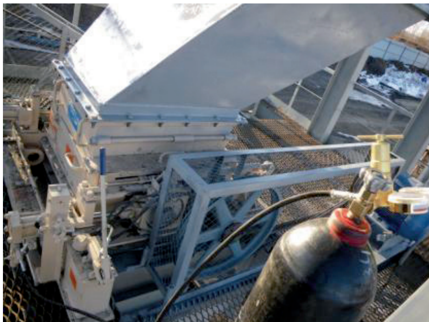
Элементы управления системой регулировки размера дробимого продукта и сброса недробимого предмета – NITROIL – на двухвалковой дробилке Gundlach 3030S.
