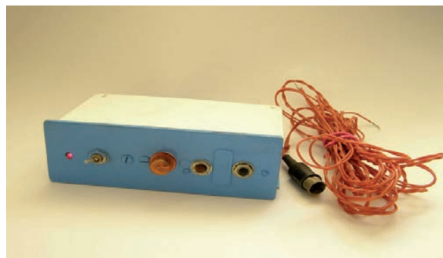
Рис. 3. Взрывной прибор конденсаторный ВПК.
