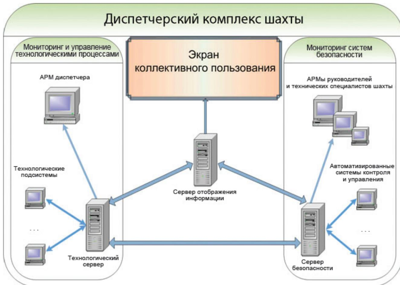
Рис. 1. Структурная схема диспетчерского комплекса.
