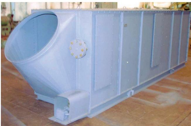
Предназначен для охлаждения воздуха в подготовительных и очистных выработках глубоких шахт, опасных по газу и пыли. Состоит из двух блоков: компрессорно-конденсаторного и воздухообрабатывающего, хладоновые системы которого соединяются на месте эксплуатации гибкими трубопроводами. Разработан учеными научно-исследовательской лаборатории кондиционирования рудничного воздуха совместно со специалистами завода «Холодмаш» (Одесса).
