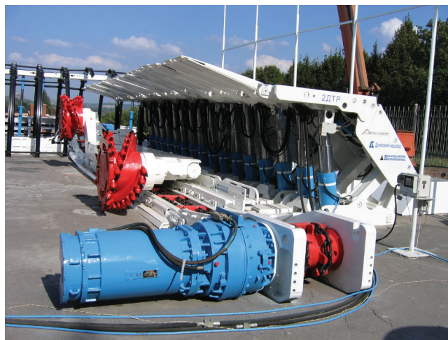
Рис. 2. Привод конвейера КСД27 с водяным охлаждением планетарного редуктора и двухскоростного электродвигателя.
