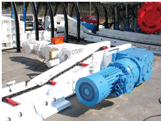
Рис. 1. Привод конвейера СП26У с односкоростным электродвигателем и гидромуфтой.
