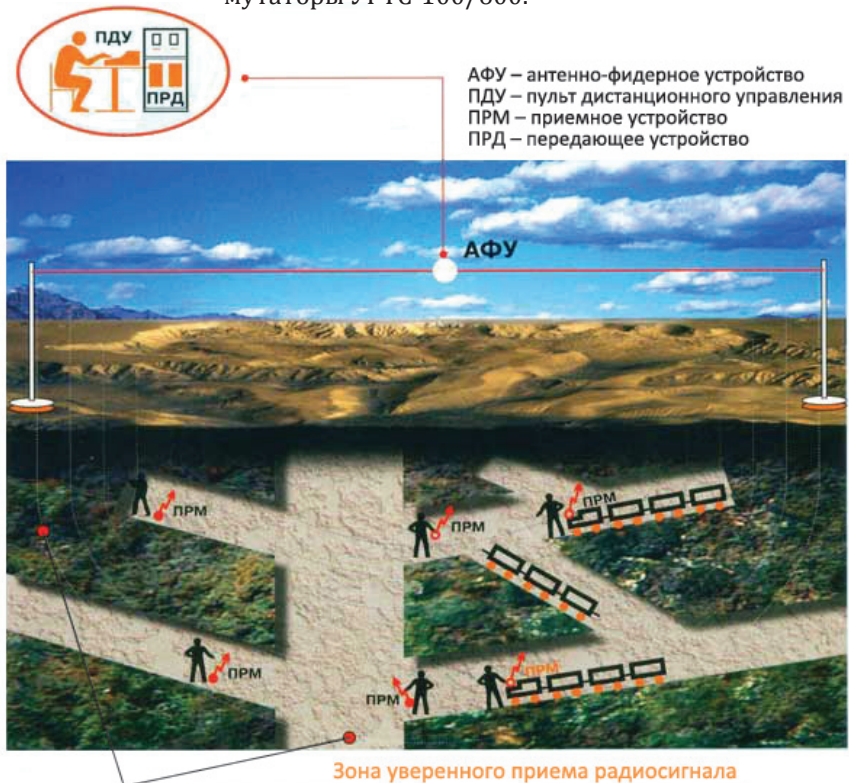
Рис. 2. Принцип действия системы «Радиус-2».
