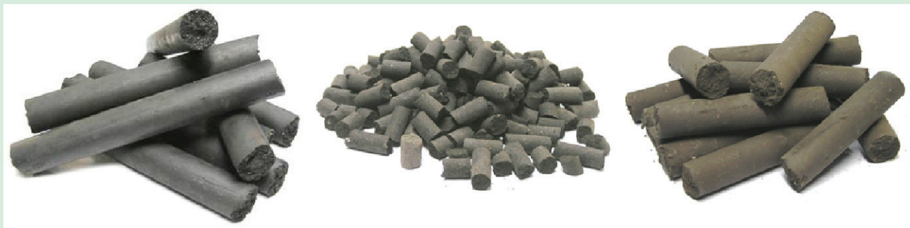
Рис. 3. Готовое окускованное топливо: а – антрацитовый шлам; б – торф; в – бурый уголь.
