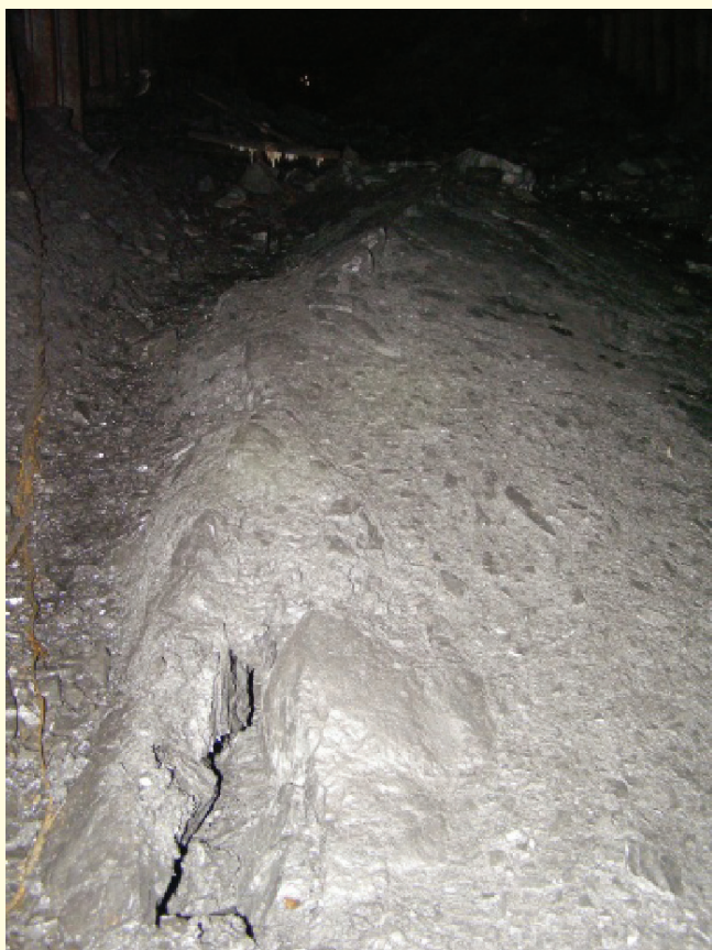
Рис. 6. Состояния вентиляционного уклона № 3: а, б, в – пройденного по выработанному пространству 1-й лавы соответственно Ф. 1 – Ф. 3; г и д – 9-й лавы соответственно Ф. 4 и Ф. 5 (см. рис. 5).
