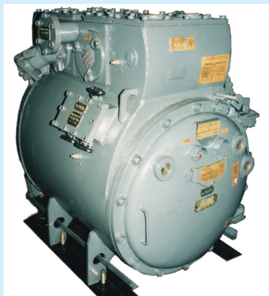
Рис. 1. Внешний вид КРУ в традиционном исполнении с болтовым соединением крышки аппаратного отделения.
