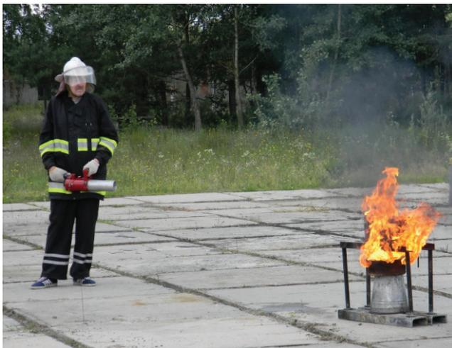
Рис. 2. Тушение модельного очага горящего дерева на сертификационных испытаниях распылением 1 л воды за 1 с с дистанции 3 м.
