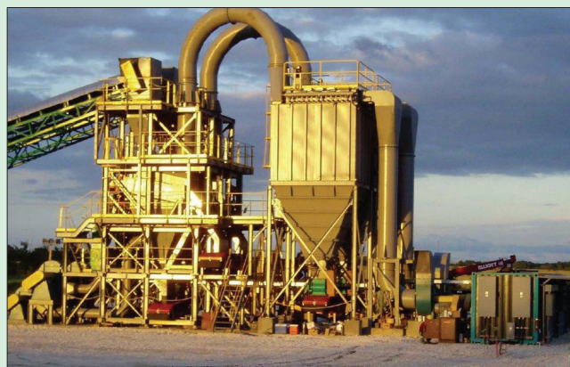
Рис. 5. Двухдечная отсадочная машина allair® производительностью 100 т/ч.
