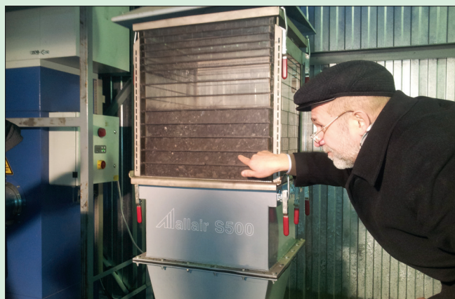
Рис. 2. Тестовые испытания каменных углей на отсадочной машине allair® для циклических тестов (г. Мыски, Кемеровская обл.).
