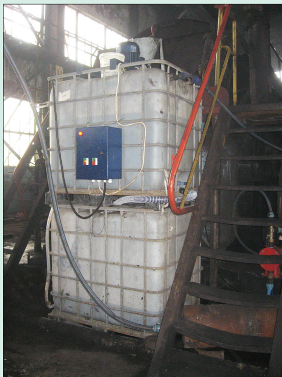
Рис. 3. Установка по приготовлению и подаче флокулянта.
