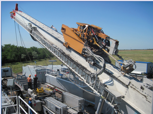
Рис. 1. Подъем мачты бурового комплекса Ultra Single 150.
