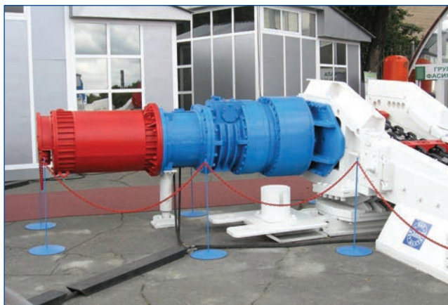
Рис. 4. Скреповый конвейер (с электродвигателем ЭДКВФ355L12/4).
