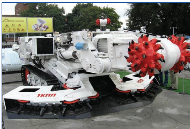
Рис. 6. Проходческий комбайн 1КПЛ (с электродвигателем ЭДКОФВ250).
