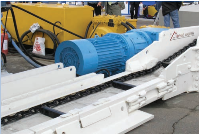
Рис. 2. Скребковый конвейер КСД27 (с конвейерным электродвигателем ЭДКОФВ315).
