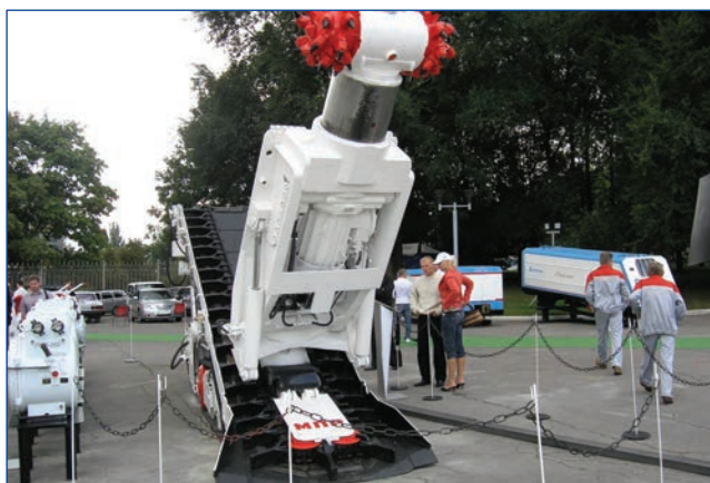
Рис. 5. Проходческий комбайн МПР (с электродвигателем ЭДКОФВ250).
