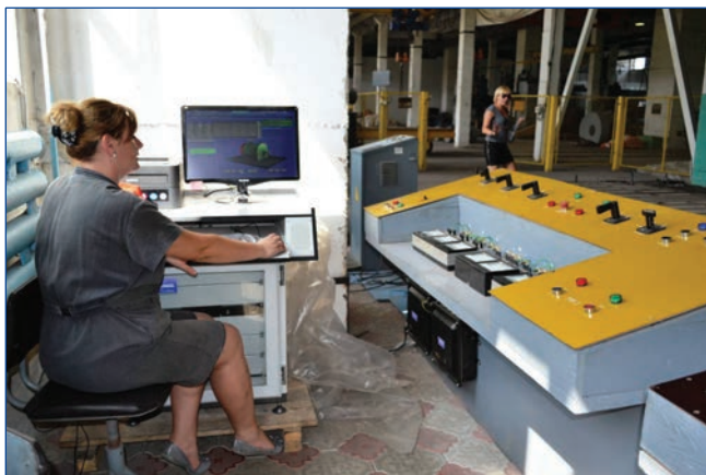
Рис. 9. Испытатель электрических машин и аппаратов Н. Ю. Товкус за работой на установке «Компакс-РПЭ» для испытания электродвигателей.
