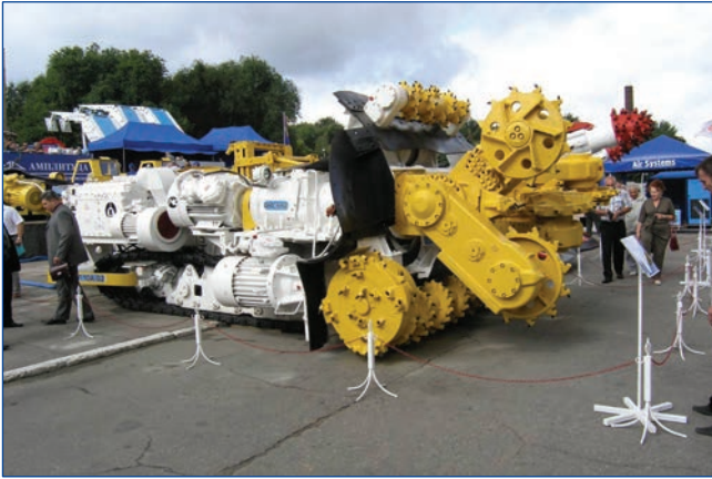
Рис. 1. Проходческий комбайн «Урал» (электродвигатель ВА02).
