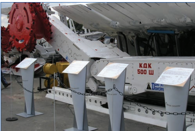
Рис. 3. Комбайн КДК500 (с электродвигателем ЭКВ5-250В).
