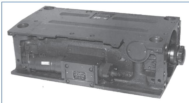
Рис. 6. Электродвигатель ЭКВЖ3,5-220.
