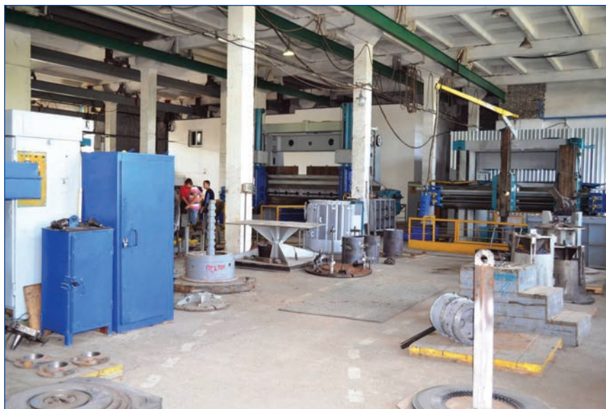
Рис. 4. Токарно-карусельные станки: слева – DKZ4000, справа – «Титан».
