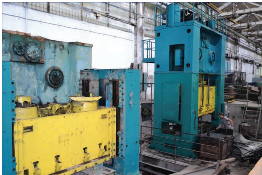
Рис. 6. Наладчик холодно-штамповочного оборудования А. В. Ильницкий за наладкой двухкривошипного прессы KB3539 усилием 8000 кН.
