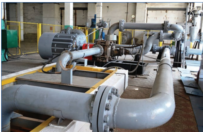
Рис. 2. Стенд для испытания центробежных насосов.
