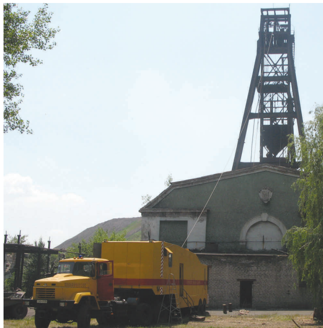
Рис. 7. Використання мобільної підйомної установки під час ліквідації наслідків аварії на шахті ім. Карла Маркса ДП «Орджонікідзевугілля».
