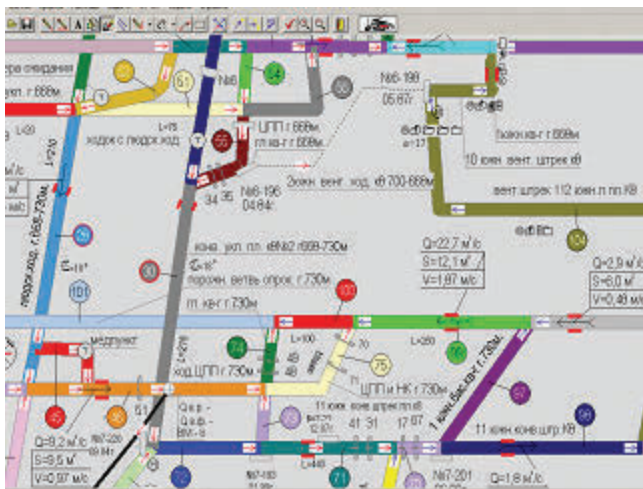
Рис. 6. Комп'ютерна схема гірничих виробок (фрагмент плану ліквідації аварії).
