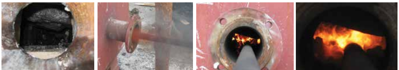
Рис. 2. Розпалювання вугільного пласта і пропалювання реакційного каналу.
