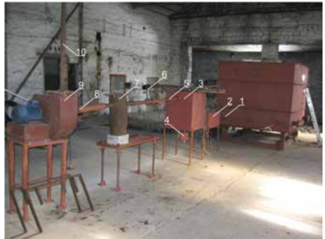
Рис. 1. Експериментальна установка для досліджень процесів свердловинної підземної газифікації вугілля: 1 – експериментальний стенд; 2 – бак-розширювач; 3 – бак-охолоджувач; 4 – відстійник для відбору конденсату; 5 – штуцер для відбору проб газу; 6 – витратомір; 7 – вапняковий фільтр; 8 – кран контролю тиску і газу; 9 – димовідсос; 10 – газовідвідна труба.
