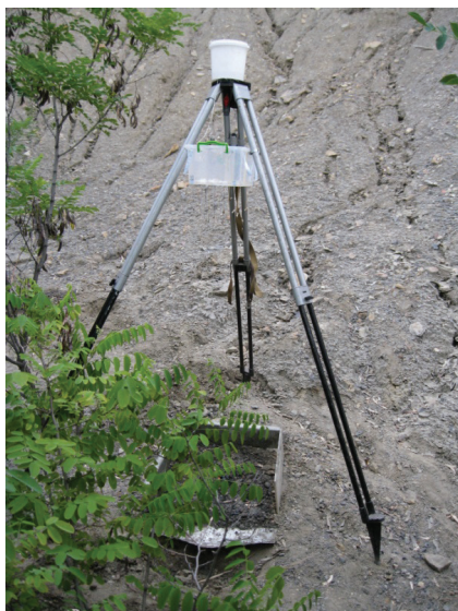
Рис. 3. Установка для моделювання зливових опадів.
