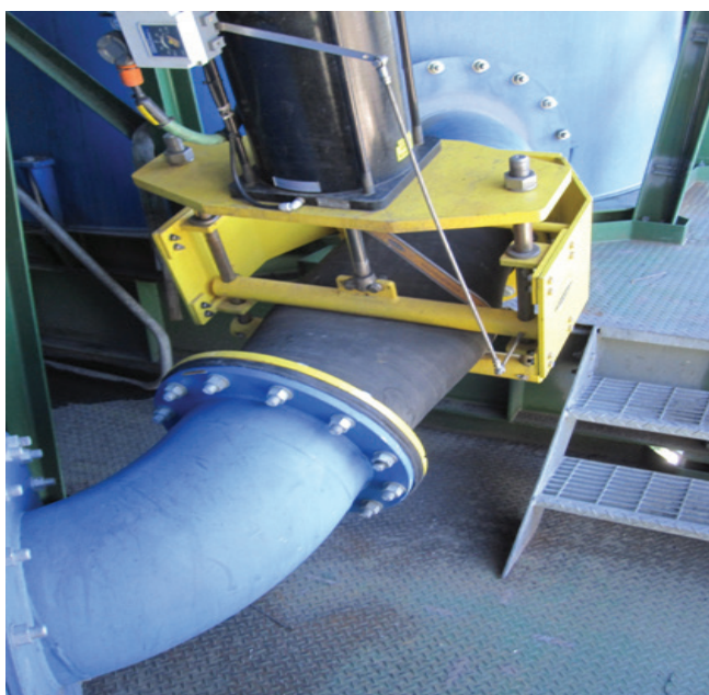
Рис. 7. Автоматическая пережимная задвижка на трубе разгрузки хвостов из флотоколонны.
