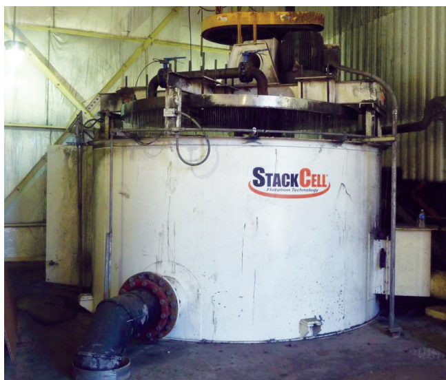
Рис. 13. Флотомашина StackCell на действующей обогатительной фабрике в США.
