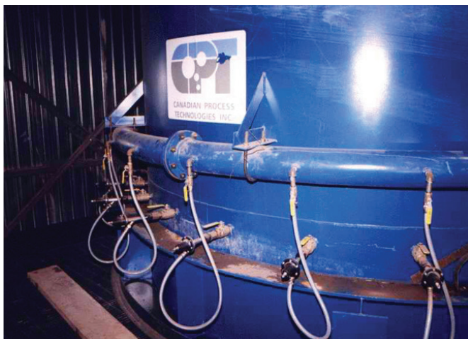
Рис. 5. Пример расположения диспергаторов воздуха на флотоколоне диаметром 4,2 м.
