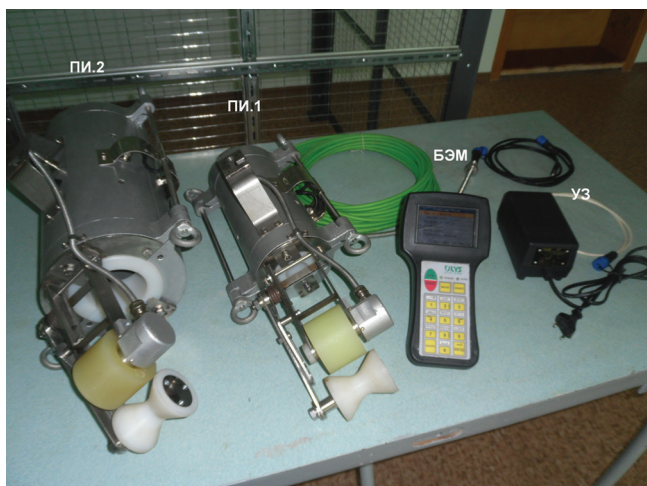
Рис. 1. Технические средства измерителя износа стальных канатов ИИСК.7.1.
