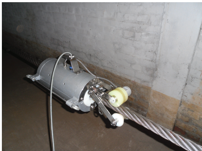
Рис. 2. Способ установки преобразователя ПИ на канате.
