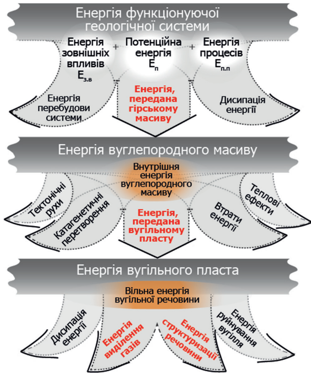
Рис. 1. Схема розподілу енергії відповідно до фізико-геологічної моделі генезису вугільного метану.
