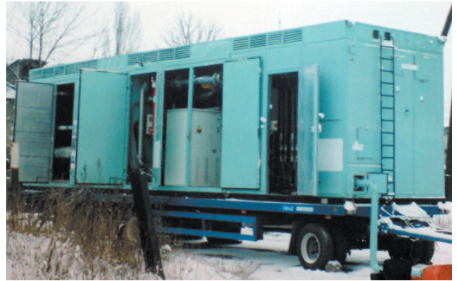
Рис. 5. Передвижная азотная станция АМВП-15/7СУ1.
