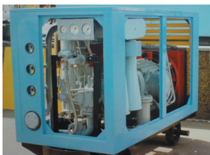
Рис. 2. Шахтная передвижная компрессорная установка УКВШ-5/7.
