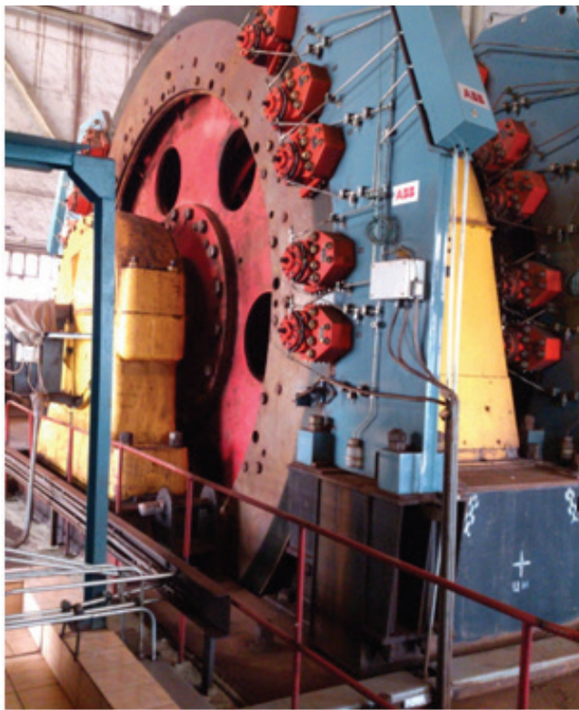
Скиповая подъемная машина ЦШ-5×4 с дисковыми тормозами (шахта им. В. И. Ленина, Криворожский ЖРК).
