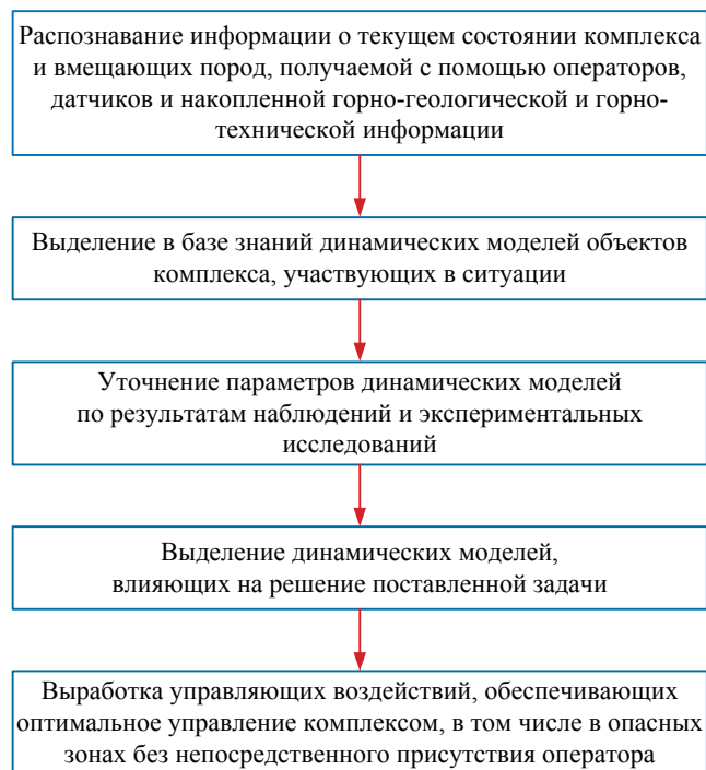
Рис. 1. Укрупненный алгоритм управления угледобывающим комплексом в условиях неопределенности.
