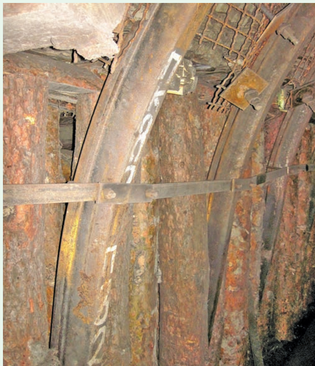
Рис. 4. Органный ряд по бровке лавы с установкой стоек между массивом и стойками металлической крепи.
