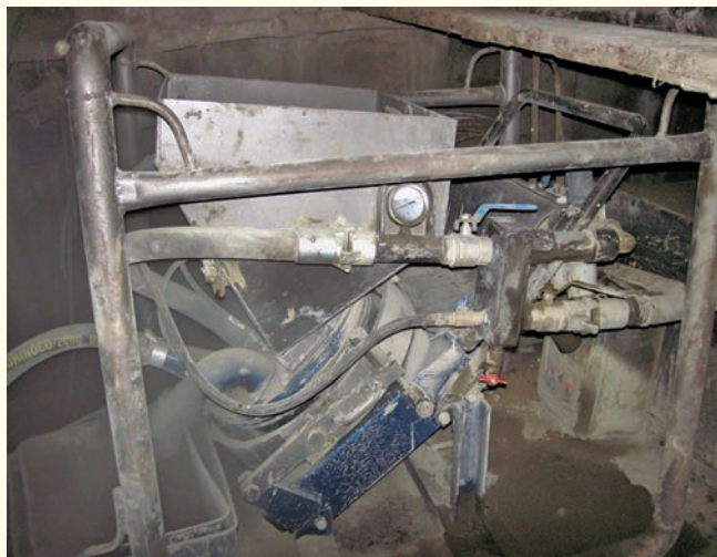
Рис. 8. Применение торкрет-установки в выработке на шахте им. Героев космоса.
