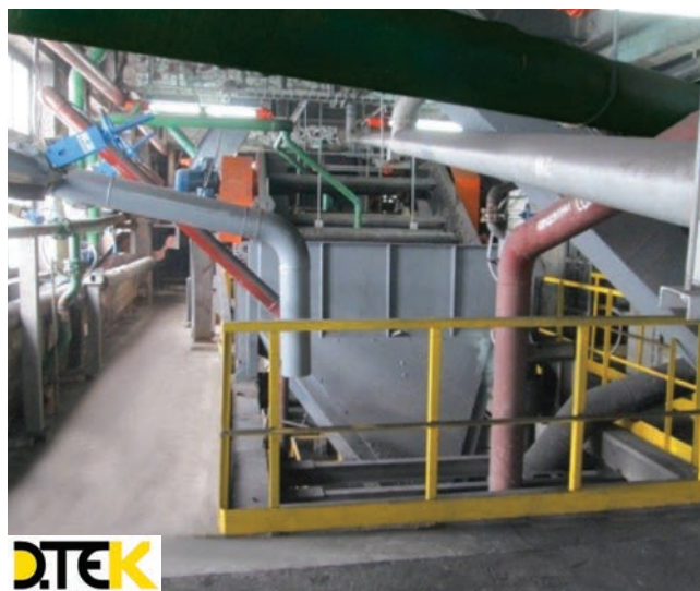
Рис. 5. Технологический комплекс: а и б – узлы установки и подготовки питания тяжелосреднего гидроциклона.
