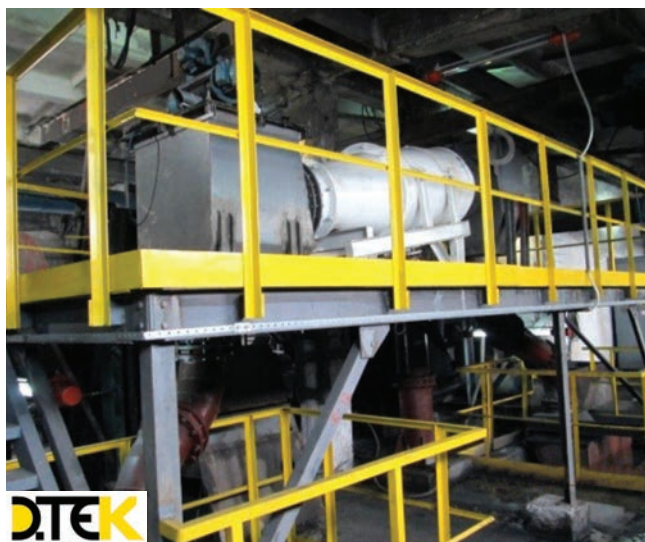
Рис. 5. Технологический комплекс: а и б – узлы установки и подготовки питания тяжелосреднего гидроциклона.
