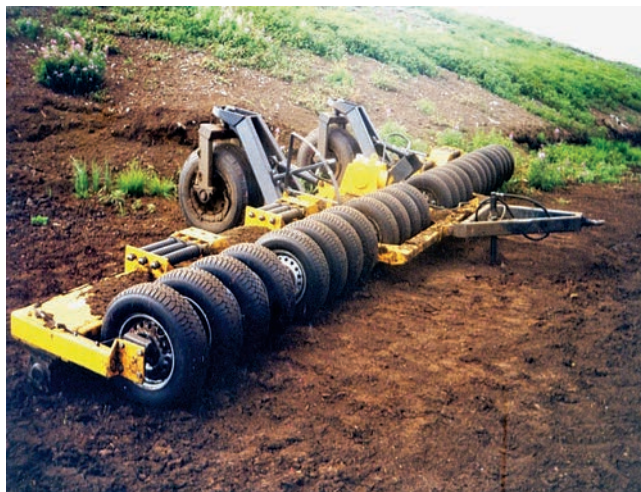
Рис. 8. Причипна машина для фрезерування торфового покладу з шасі на пневматичних шинах.
