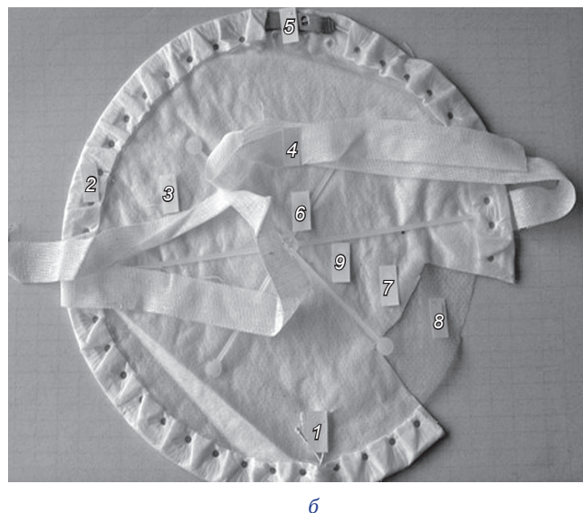
Рис. 10. Схема та загальний вигляд багат шарового одноразового фільтрувального респіратору: 1 – еластичний шнур; 2 – обтюратор; 3 – фільтрувальна півмаска; 4 – стрічки; 5 – пластина для обтискання носа; 6 – розпірка; 7 – фільтрувальні шари зі змінною за товщиною поверхневою щільністю; 8 – захисний шар зі спанбонду; 9 – підложка з гідрофільного матеріалу.
