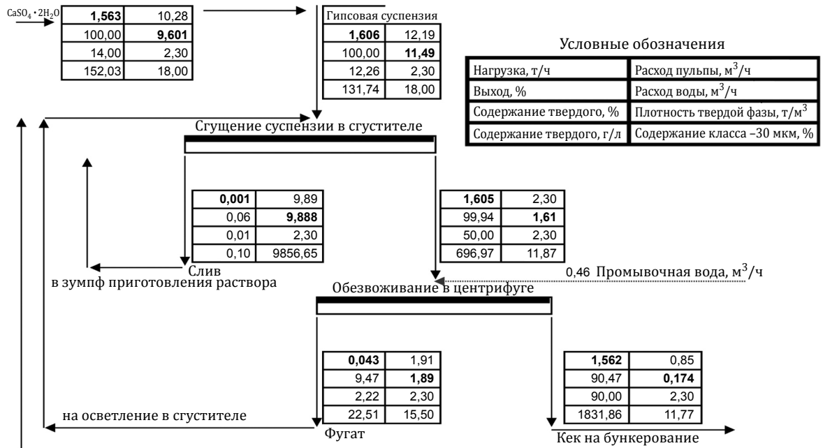
Рис. 6. Водно-шламовая схема с глубоким осветлением оборотной воды.
