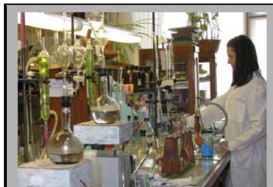
Рис. 1 Подготовка к работе установки по определению выхода химических продуктов коксования
