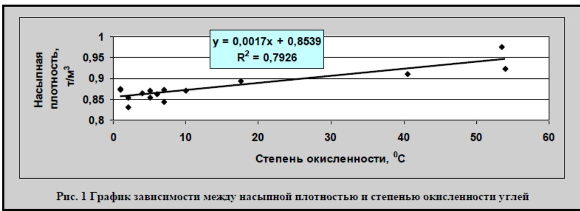
Рис. 1 График зависимости между насыпной плотностью и степенью окисленности углей
