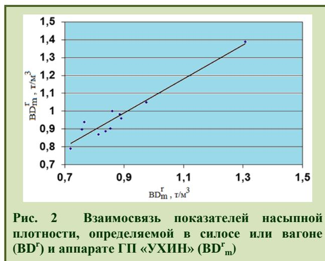
**Рис. 2** Взаимосвязь показателей насыпной плотности, определяемой в силосе или вагоне (BD<sup>r</sup>) и аппарате ГП «УХИН» (BD<sub>m</sub><sup>r</sup>)
