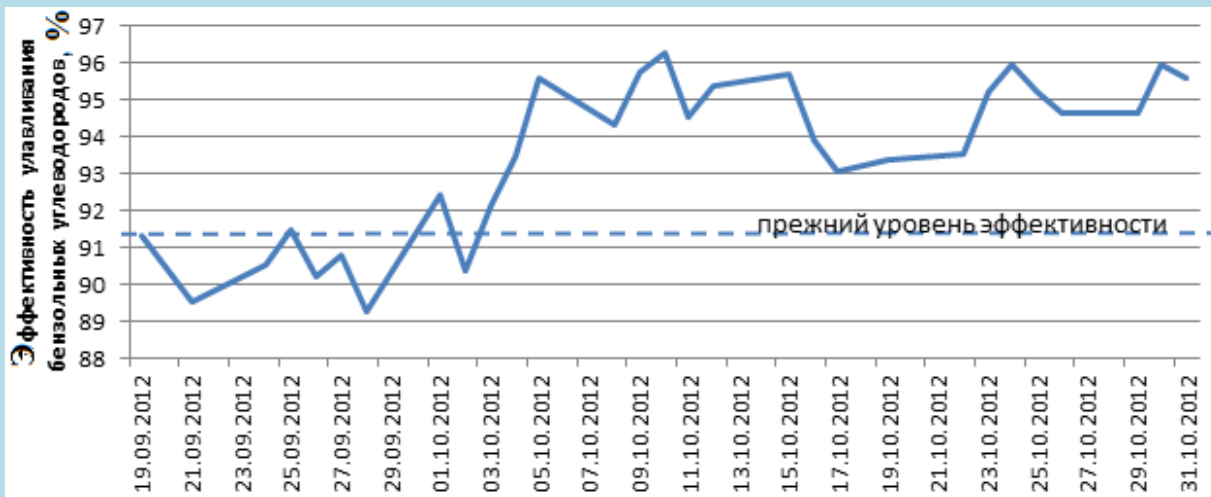
Рис. 4 Эффективность улавливания бензольных углеводородов при эксплуатации нового скруббера с насадкой «Sultzer»
