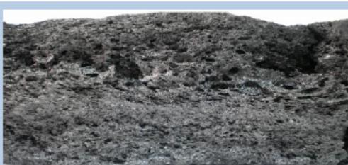
Рис. 6 Кокс, полученный из трамбованного угля марки Ж
