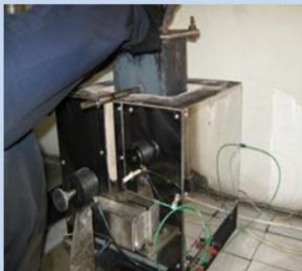
Рис. 3 Установка для определения давления расширения
