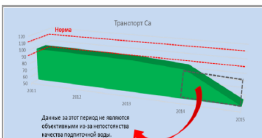
Рис. 5 Мониторинг стабилизационной обработки оборотной воды технологического цикла в течение подачи ингибитора PuroTech 48
