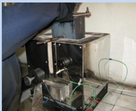
2. Установка реторты в камеру
