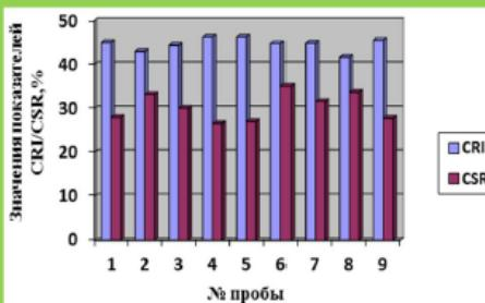
Рис. 1 Зависимость влияния различных присадок на показатели CRI/CSR коксов, полученных из насыпной шихты (бат. № 7)
