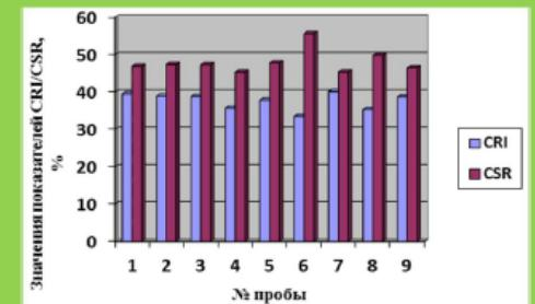
Рис. 2 Зависимость влияния различных присадок на показатели CRI/CSR коксов, полученных из трамбованной шихты (бат. № 9-бис)
