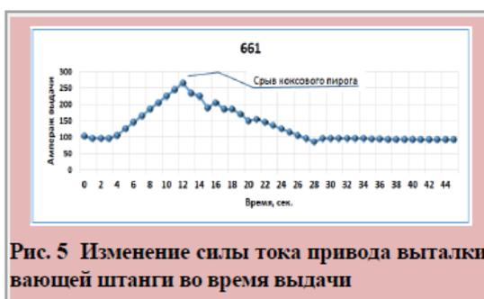
Рис. 5 Изменение силы тока привода выталкивающей штанги во время выдачи
