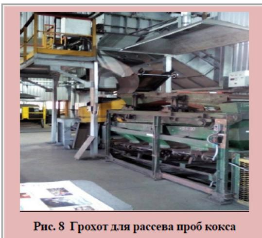
Рис. 8 Грохот для отсева проб кокса
