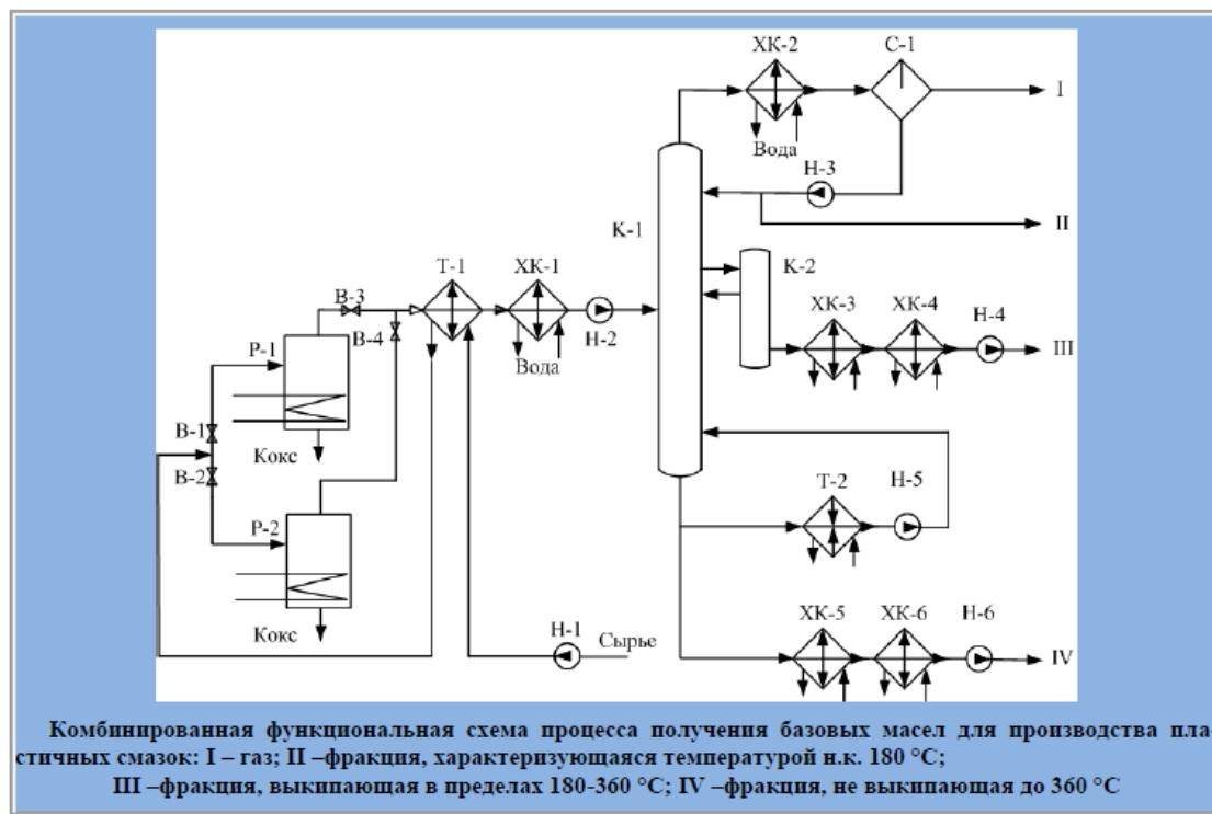
Сырье – отработанное моторное масло – подается насосом Н-1 через теплообменник Т-1, где подогревается за счет тепла, отбираемого у продуктов термического крекинга, выходящих из реактора Р-1. Подогретое отработанное масло поступает в реактор термического крекинга Р-1, где происходит его нагрев со скоростью 4-5 °C в минуту при давлении 0,11-0,14 МПа. Образовавшиеся продукты проходят теплообменник Т-1, частично подогревая сырье крекинга, а затем поступают в конденсатор-холодильник XK-1.
